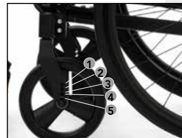
Les emplacements 1 à 5 correspondent à la position en hauteur de la roue dans la chape.
